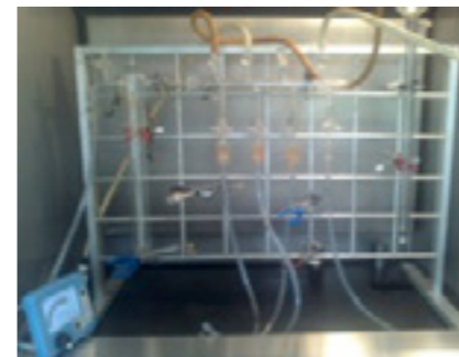
Fig. 4a. Imagen del montaje experimental para la síntesis de nanopartículas metálicas, por el método de reducción y/o desplazamiento de precursores organometálicos.
