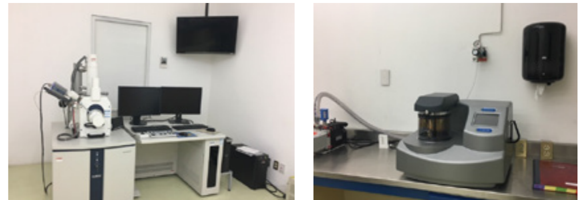
Fig. 7. Imágenes del Laboratorio de Microscopía Electrónica y del equipo para recubrir muestras con material conductor (oro o carbono), adaptado a una bomba de vacío y a una alimentación de gas argón.
